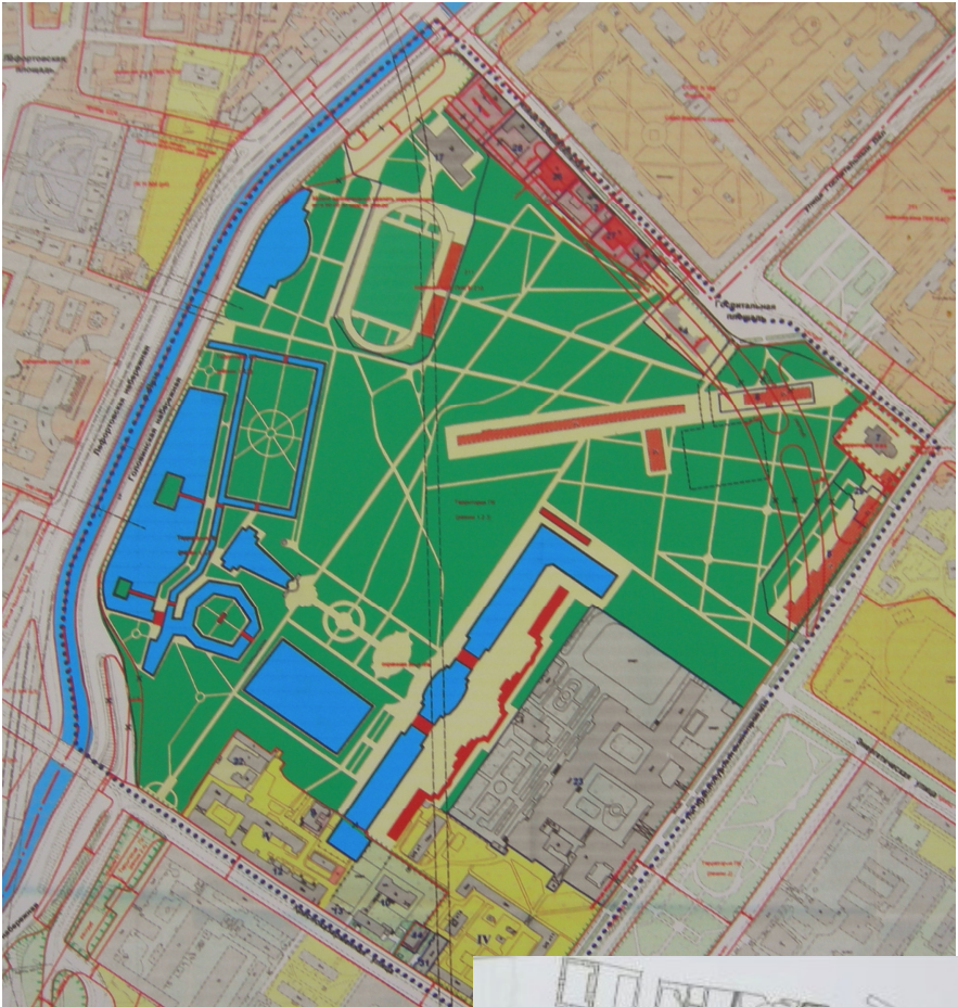
Afb. 9 en 10. Watersysteem in Lefortovo-park aan de Jauza, boven anno 2010; rechts circa 1730. Uitgevoerd o.l.v. de Hollandse arts Nicolaas Bidloo. Noorden boven. De hoogste bassins liggen rechts; de rivier de Jauza links. Foto OHT.
